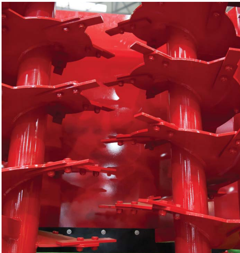
Вертикальный двухвальцовый адаптер обеспечивает широкий и точный разброс и высокую производительность.
