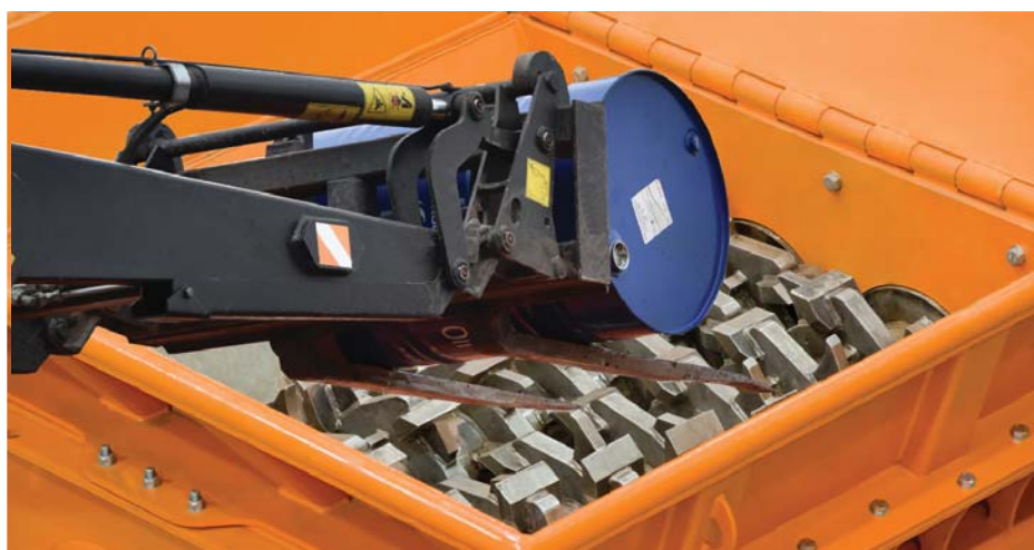
Синхронная система работы валов позволяет достичь очень высокую производительность
