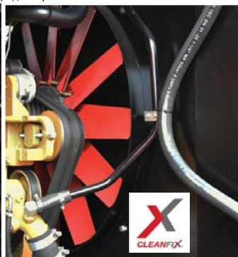
Система Cleanfix автоматически очищает радиаторы
