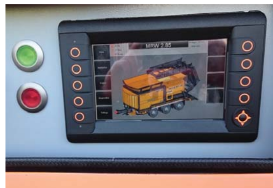
Сенсорная панель управления всеми функциями машины
