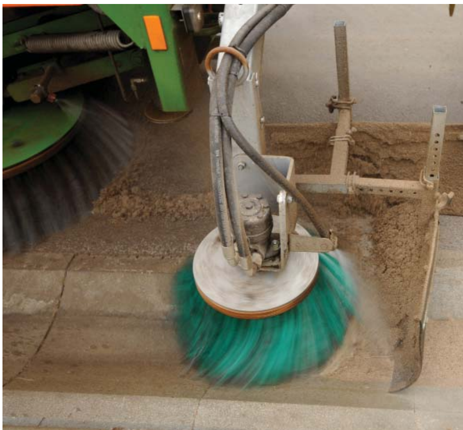
Боковая щетка ZMC 3.0 подходит для сложных дорожных дренажных каналов.
