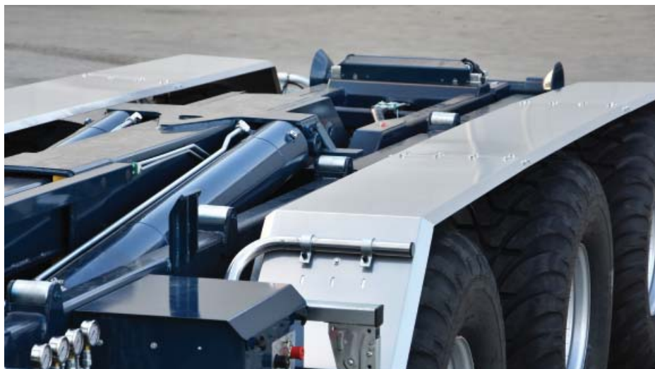
Стабильная рама с двумя гидроцилиндрами
