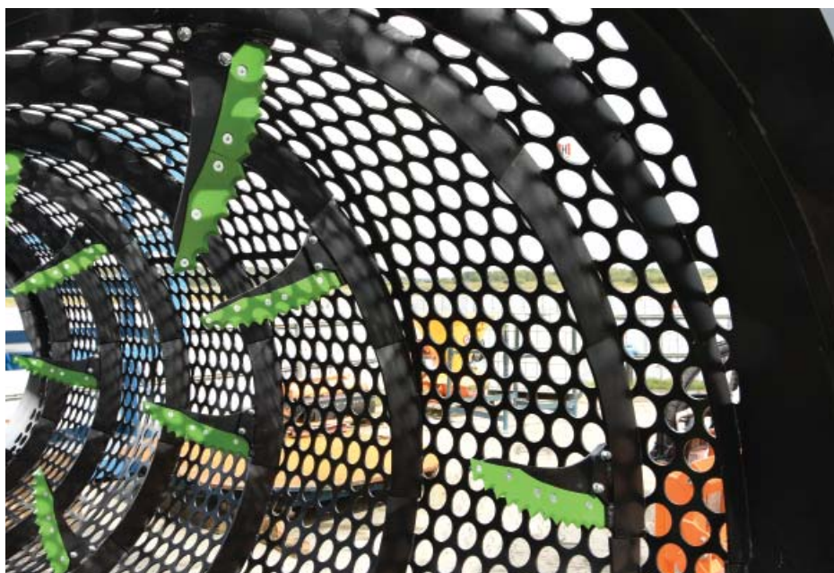
Барабан для просеивания коммунальных отходов. Ножи облегчают отделение пластиковых пакетов.
